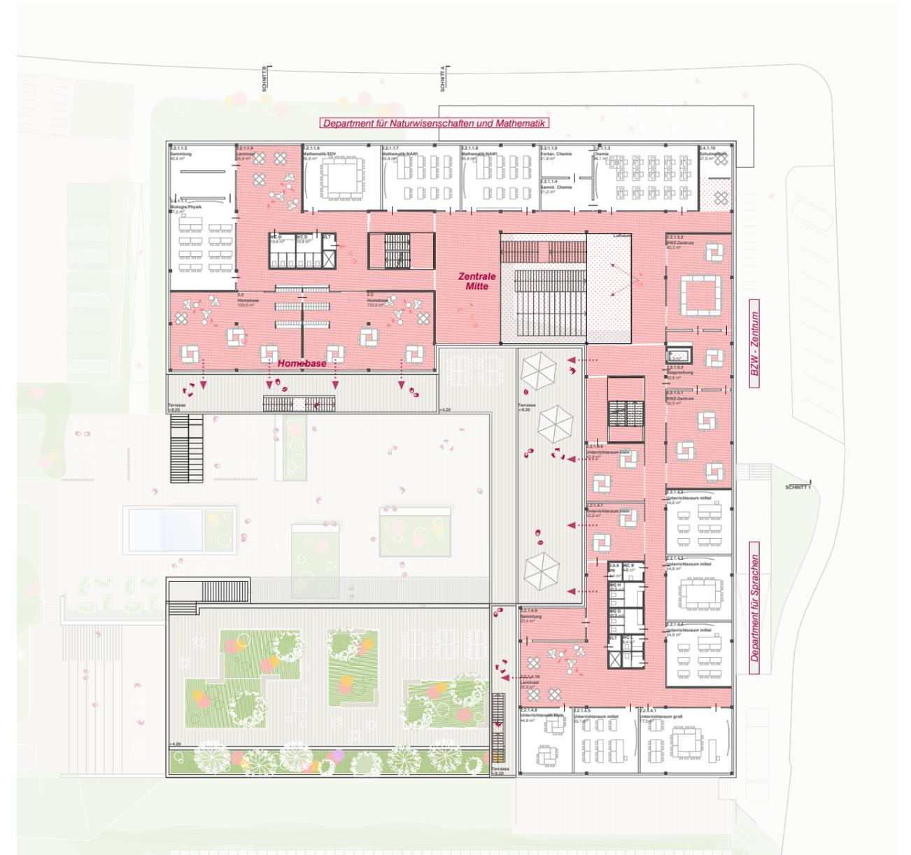
Durch die einfache Geometrie mit einem klaren Achsraster und wirtschaftlichen Spannweiten wird eine serielle Konstruktion mit vorgefertigten Decken- und Wandelementen ermöglicht und die Bauzeit verkürzt.
